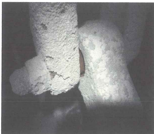
Powierzchnia bijaka młotka oraz luz na połączeniu z ramieniem.
