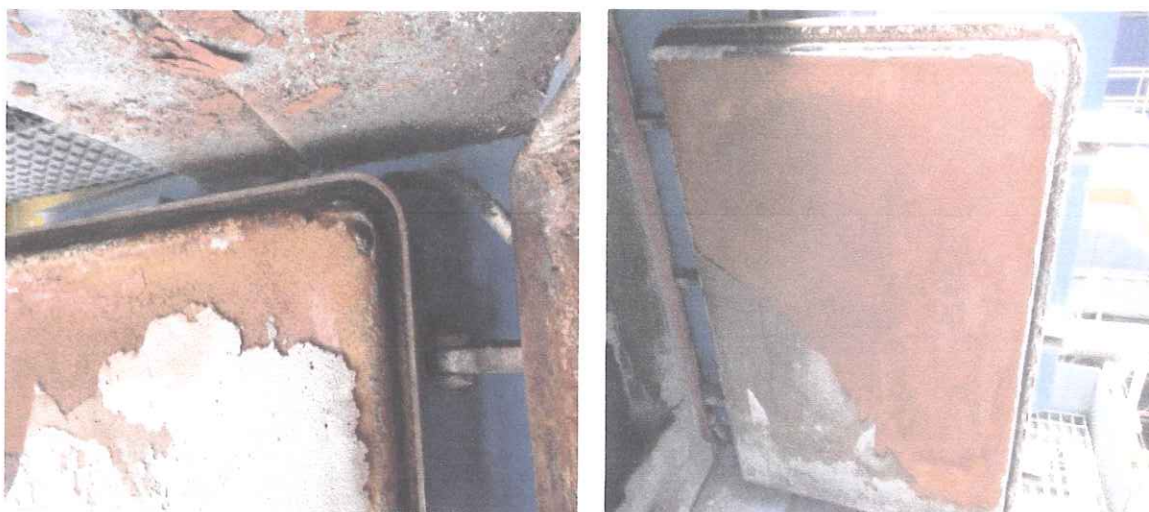
Przekorodowane wewnętrzne powierzchnie wjazdów w III strefach
